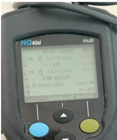
*Figura 3 resultados de ph y conductividad de la primera muestra*
