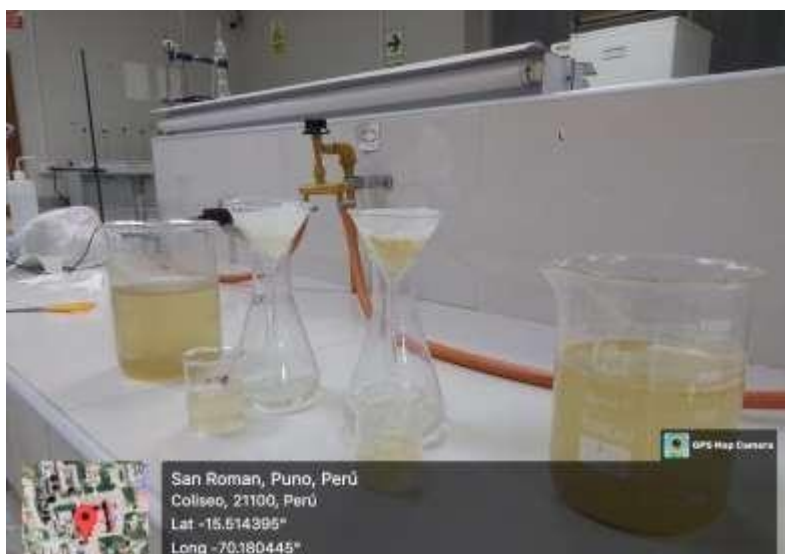
Figura 6: Filtración de las 2 muestras.
